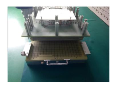
ICT测试治具的应力测试为什么很重要?为了找出问题,避免犯错误,你可以在印刷电路板上做一个应变测试,并测量了大应力在产生高压时的大应力,而应力是在允许的范围内。如果测得的应力值,电路板上的允许水平力大值,您可以重新制造或ICT测试治具的设计,或根据变化过程的要求(一般是调节顶针,减少测试时,顶压的电路板),应变值降低到允许范围内□IPC/jedec-9704标准识别有缺陷的组件和ICT测试程序,并提供PCB应变测试程序进行了系统的实现。即使是一个很好的夹具的设计也会在印刷电路板上太长时间产生很大的压力。
