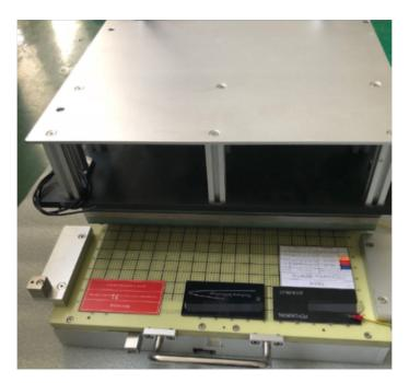
ICT在线测试仪在测试的过程中有哪些细节是需要我们注意的? 1、虽然有双面ict治具,但将被测点放在同一面。2、被测点优先顺序□A.测垫(Testpad)□B.零件脚(ComponentLead)□C.贯穿孔(Via)□3□两被测点或被测点与预钻孔之中心距不得小于0.050"□1.27mm□□以大于0.100"□2.54mm□为佳,其次是0.075"□1.905mm□□4□被测点应离其附近零件(位于同一面者)至少0.100″,如为高于3m/m零件,则应至少间距0.120″。5、被测点应平均分布于PCB表面,避免局部密度过高。广州在线ICT自动化测试治具多少钱ICT测试治具是一种不断开电路,不拆下元器件管脚的测试技术。
